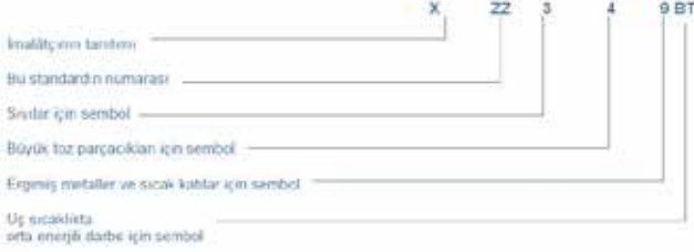
Şekil 6.4 TS 5560 EN 166 farklı kullanım alanları için çerçevelerin işaretlemesi
