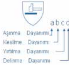
Şekil 6.1 TS EN 388 Mekanik risklere karşı koruyucu eldiven piktogramı
